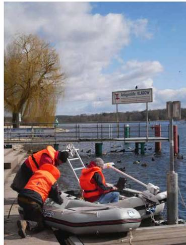
verborgenen Prozesse, verstärkt in den Blick nehmen. Dies ist jedoch nicht mit den an Land gängigen Techniken möglich. Gemeinsam mit dem AWI haben wir dann ein spezielles Ozean-Boden-Seismometer (OBS) für Flachwasser entwickelt (Anm.: „silberne Apparatur“ s. Foto). Das Gerät nimmt Schallwellen – ähnlich wie in der Erdbebenerforschung – auf dem Gewässergrund auf und war im Praxistest vor Kladow.
